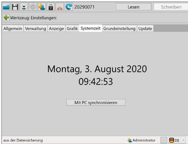
Unter Systemzeit kann die Real-Time-Clock (RTC) des Werkzeugs mit der Uhrzeit des PC's synchronisiert werden.
