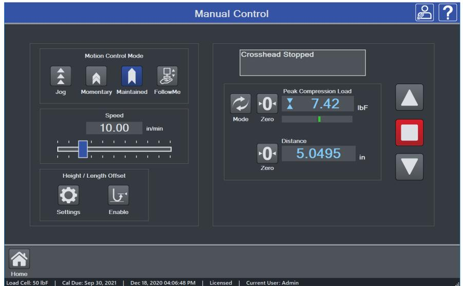
Mit Mark-10's innovativer **FollowMe®** Funktion ist es möglich durch drücken und ziehen am Kraftsensor, das Kopfteil zu bewegen. Durch Steigerung der Kraft erreichen Sie eine schnellere Bewegung des Kopfes. **FollowMe®** ist geeignet für schnelles Positionierungen sowie Feineinstellungen des Kopfteil.
