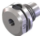
Das patentierte System der Festhaltemundstücke ist optimal zum Senkrechtenieten oder für schwer erreichbare Stellen geeignet, da der Niet im Mundstück festgehalten wird. Der Nietdorn kann nach dem Nietvorgang nicht in das Werkstück fallen.
