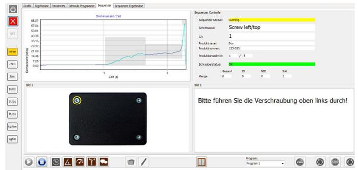
Beispielhafte Instruktionen an den Bediener bei einem Schraubschritt
